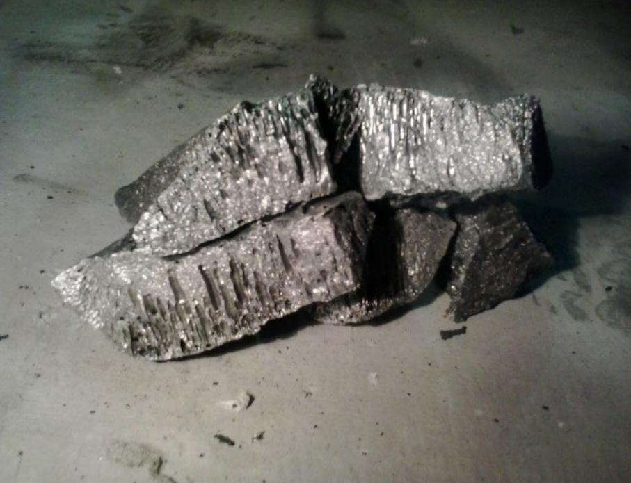
**При основности 0,4 и 0,5 на выпуске шлак был вязковатым, густым и его приходилось скачивать. В третьем варианте шихты, при основности 0,6 наблюдалось улучшение технологических показателей: металл выходил активно, а шлак был текучим.**
